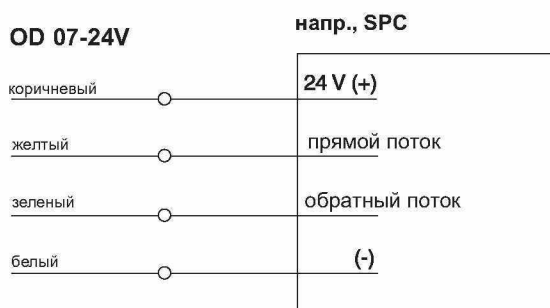
Схема подключения OD 07-24V
